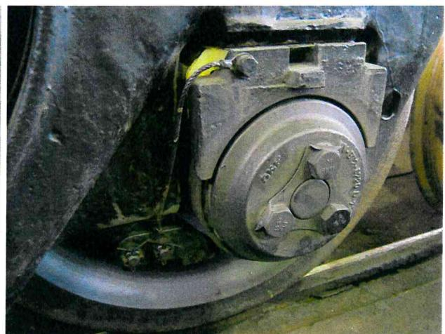
**A.4. Трещина/излом полимерной вставки между опорной поверхностью
