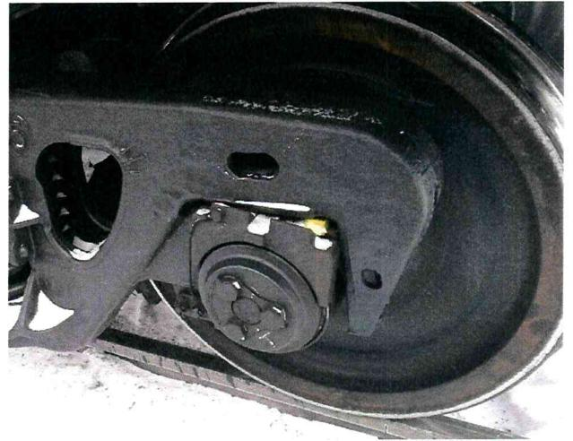
**A.5. Отсутствие/обрыв/ослабление одного или более болтов торцевого
