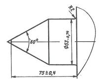
Рисунок 19.1 - Конусная часть центра пиноли колесотокарного станка
