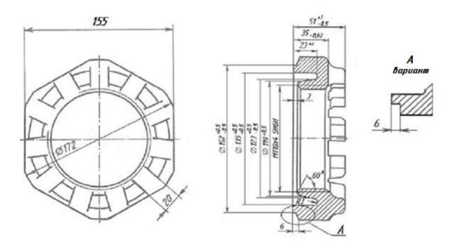
Рисунок 10.7 - Гайка торцевая М110х4 5Н6Н
