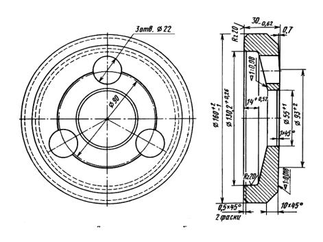
Для крепления тремя болтами M20 на шейке оси типа РУ1Ш Рисунок 10.9 - Шайба тарельчатая
