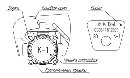
Рисунок 9.7 - Внешние отличительные признаки буксового узла с подшипником кассетного типа в габаритных размерах 130х250х160мм торговой марки Бренко
