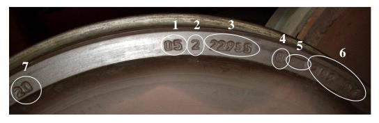
1 - две последние цифры года изготовления колеса; 2 - марка стали; 3 - номер плавки; 4 - условный номер предприятия-изготовителя колеса (номер или его торговая марка); 5 - приемочные клейма; 6 - порядковый номер колеса по системе нумерации предприятия-изготовителя; 7 - код государствасобственника колеса, наносится в двух местах: первое клеймо - на расстоянии 150...200 мм перед основной маркировкой, второе - с диаметрально противоположной стороны.
