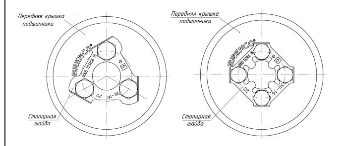
Рисунок 9.8 - Внешние отличительные признаки подшипников кассетного типа в габаритных размерах 130х230х150мм, 130х250х160мм и 150х250х160мм под адаптер торговой марки Бренко
