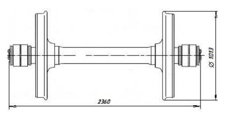
Рисунок 8.4 - Колесные пары типа РУ1Ш-957-Г и РВ2Ш-957-Г с подшипниками под адаптер. Габаритные размеры
