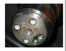
Следы герметика в резьбовых отверстиях осей
