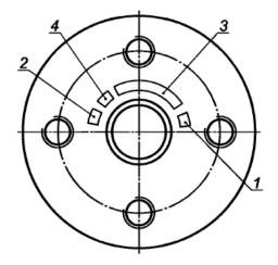
1- приемочные клейма, 2 - условный номер предприятия – изготовителя чистовой оси; 3 - номер оси, включающий условный номер предприятия-изготовителя черновой оси - 4 знака (если условный номер менее 4 знаков, его дополняют нулями с левой стороны), порядковый номер черновой оси - до 6 знаков, две последние цифры года изготовления черновой оси – 2 знака; 4 - клеймо службы технического контроля предприятия-изготовителя чистовой оси.
