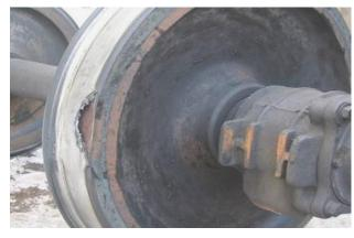
Определение Визуальный контроль. Восстанавливают профиль поверхности геометрических параметров откола. катания колес.
