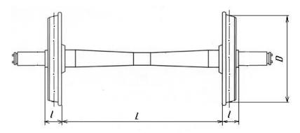
Рисунок 8.2 - Колесная пара типа РУ1-957-Г без буксовых узлов
