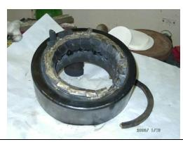
Визуальный контроль, использование напольных средств автоматического контроля буксовых узлов в пути следования. При движении поезда искрение, выделение дыма, запах гари, движение колесной пары юзом.
