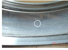
Визуальный контроль. По внешнему виду дефект имеет вид кратера, при рассмотрении с увеличительного использованием стекла донышко кратера темного или серого цвета со следами оплавления.
