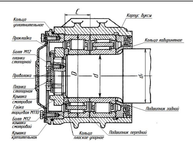
Рисунок 9.2 - Буксовый узел с двумя подшипниками роликовыми цилиндрическими с торцевым креплением гайкой торцевой M110
