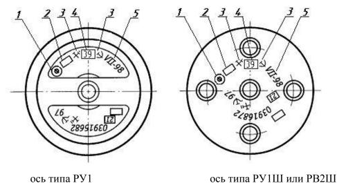
1 - «Ф» - знак формирования колесной пары; 2 - клеймо ОТК; 3 - приемочные клейма; 4 - условный номер предприятия, которое произвело формирование колесной пары; 5 – дата формирования колесной пары (месяц римскими цифрами и две последние цифры года).
