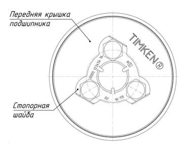
Рисунок 9.14— Внешние отличительные признаки подшипников кассетного типа в габаритных размерах 150х250х160мм под адаптер торговой марки TIMKEN
