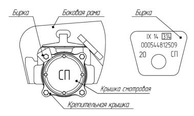
Рисунок 9.4 - Внешние отличительные признаки буксового узла с подшипником сдвоенным
