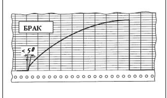
Скругление радиусом 5 мм кромки отверстия со стороны внутреннего торца ступицы колеса.
