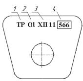
1 - знак проведения текущего ремонта колесной пары; 2 - О1 или О2 - знак восстановления профиля поверхности катания колес (если производилось); 3 – дата проведения текущего ремонта и восстановления профиля поверхности катания колес (месяц римскими цифрами и две последние цифры года) 4 - условный номер ремонтного предприятия, которое провело текущий ремонт и восстановления профиля поверхности катания колес.
