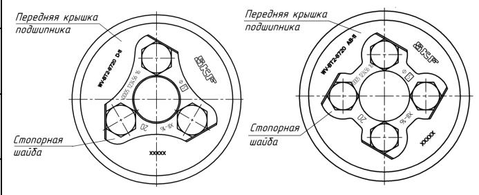
Рисунок 9.12 - Внешние отличительные признаки подшипников кассетного типа в габаритных размерах 130х230х160мм, 130х250х160мм и 150х250х160мм торговой марки SKF под адаптер
