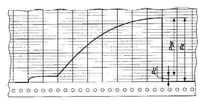
Рисунок 29.4 Диаграмма с записью холостого хода плунжера пресса
