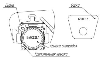
Рисунок 11.1 - Отличительные признаки буксового узла с подшипниками роликовыми цилиндрическими, заправленного смазкой Буксол или ЗУМ
