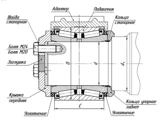
Рисунок 9.13 – Подшипник кассетного типа в габаритных размерах 150x250x160мм торговой марки TIMKEN под адаптер
