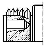
Механическое повреждение резьбы М12 осей РУ1
