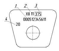
1 - индивидуальный номер колесной пары; 2 - дата проведения среднего ремонта колесной пары (месяц римскими цифрами и две последние цифры года); 3 - условный номер ремонтного предприятия, которое произвело средний ремонт колесной пары; 4 - код государства-собственника колесной пары.
