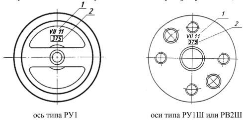
1 – дата проведения среднего ремонта колесной пары (месяц римскими цифрами и две последние цифры года); 2 - условный номер ремонтного предприятия, которое произвело средний ремонт колесной пары.
