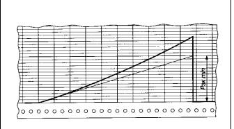
Наличие попутных конусов или впадин на посадочных поверхностях оси и колеса.
