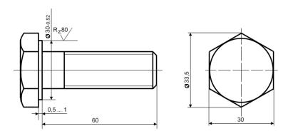
Рисунок 10.11 - Болт M20-6gx60.4.8 с резьбой, выполненной методом накатки
