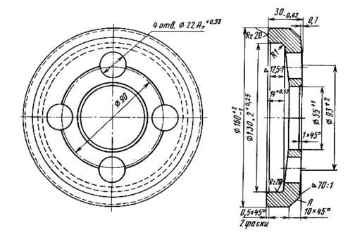
Для крепления четырьмя болтами М20 на шейке оси типа РУІШ
