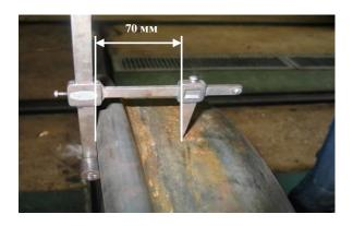
Визуальный контроль и замеры. Измерение толщины обода производят наличии При колесе толщиномером. на ползуна или выщербины толщину обода определяют месте расположения В неисправности.
