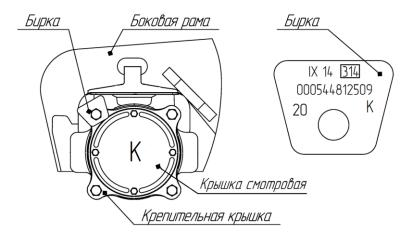
Рисунок 9.11 - Внешние отличительные признаки буксового узла с подшипником кассетного типа в габаритных размерах 130х250х160 мм торговой марки SKF
