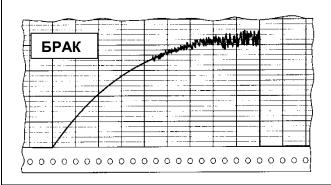
Наличие воздуха в гидравлической системе пресса, разжижение масла, применяемого для смазки посадочных поверхностей.
