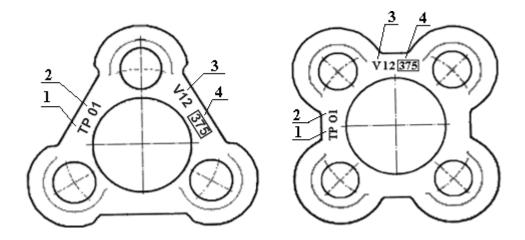
1 - знак проведения текущего ремонта колесной пары; 2 - О1 или О2 - знак восстановления профиля поверхности катания колес (если производилось); 3 — дата проведения текущего ремонта и восстановления профиля поверхности катания колес (месяц римскими цифрами и две последние цифры года); 4 - условный номер ремонтного предприятия, которое провело текущий ремонт и восстановления профиля поверхности катания колес.
