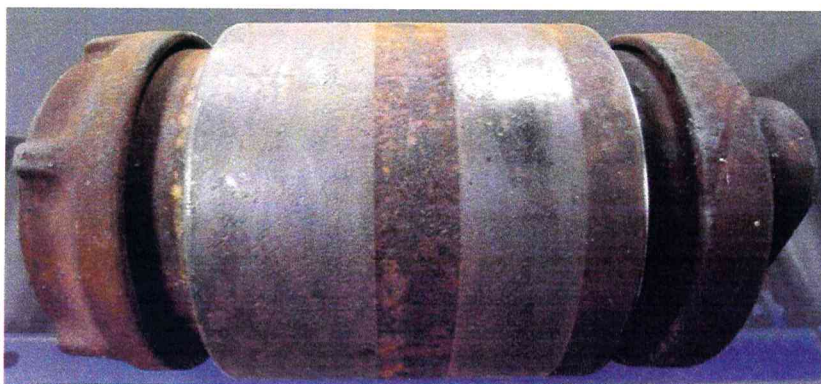
Рис. Г.5 Следы на наружном кольце подшипника, указывающие на чрезмерный износ адаптера (несимметрично расположенные полосы различной ширины, достигающие до края подшипника, блестящая кромка наружного кольца)
