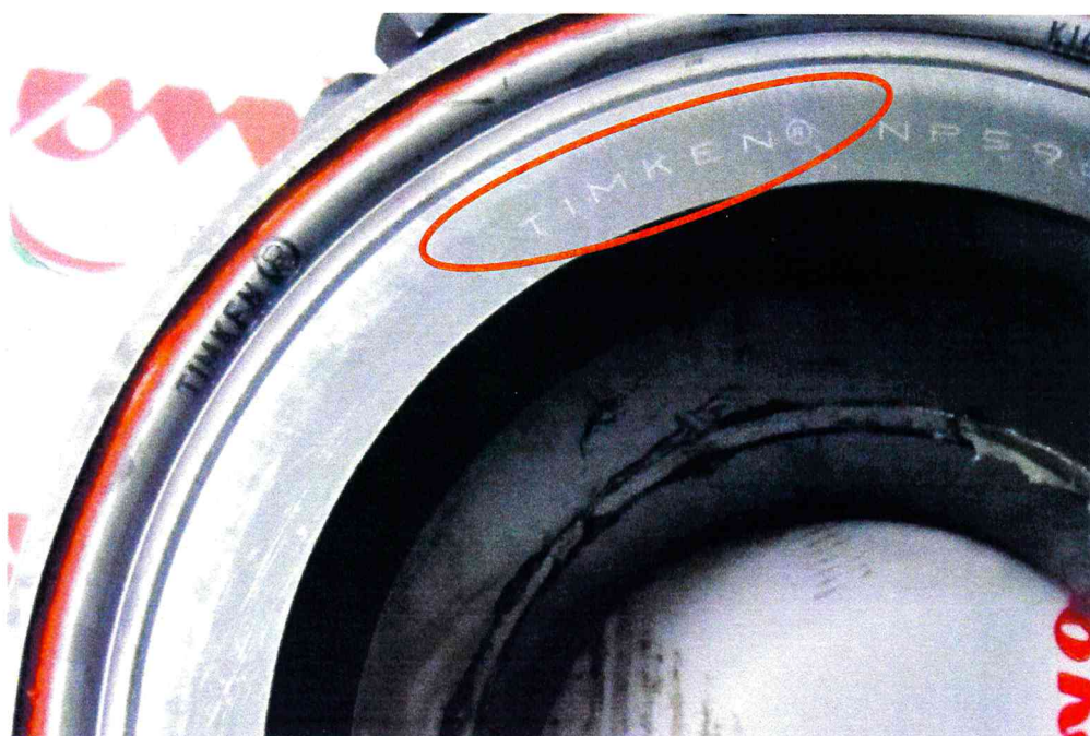
Рис Б.9 Маркировка внутреннего кольца кассетного подшипника торговой марки TIMKEN
